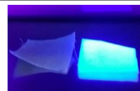
ブラックライト照射の様子 (右: 酸化チタン溶液 左: 純水)
